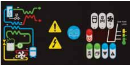
El controlador avanzado del microprocesador proporciona control intuitivo sobre las funciones del secador y el estado de funcionamiento.
