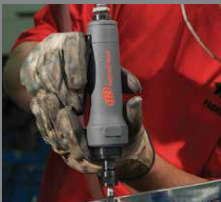
Säubern und Glätten nach Schweißarbeiten
