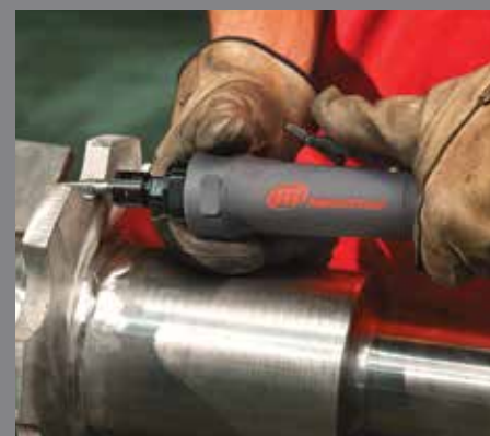
Ébavurage et travaux de finition
