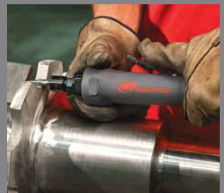
Desbarbado y acabado de los cantos
