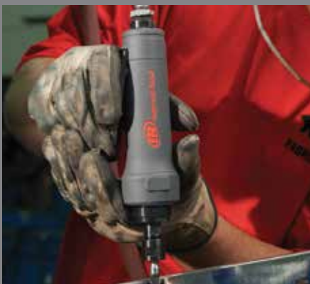
Limpieza y alisado tras la soldadura
